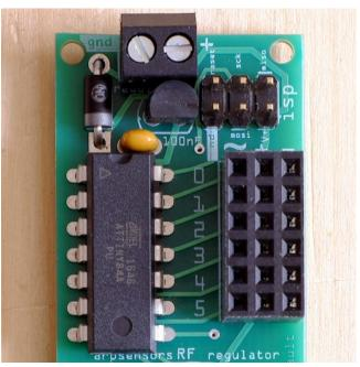
On peut maintenant mettre en place le connecteur ISP (male 6 pin) et le connecteur femelle à 3 rangées.
