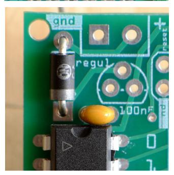
Soudez ensuite la diode en faisant attention à la polarité, bande grise vers le bas. Puis le petit condensateur, il n'est pas polarisé.
